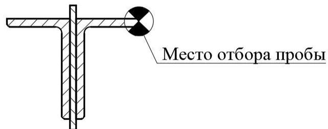
**Рисунок 37 – Схема отбора пробы из незакрепленного элемента профиля – полки уголка**
