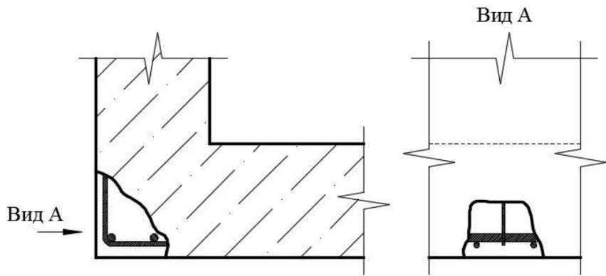
**Рисунок 45 – Пример схемы вскрытия нижнего армирования плитного фундамента**
