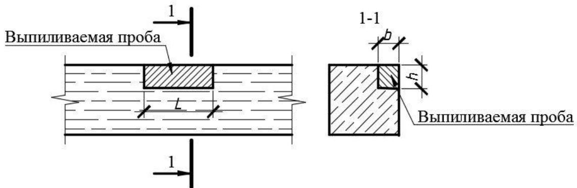
$L$  – длина выпиливаемой пробы;  $b$  – ширина выпиливаемой пробы;  $h$  – высота выпиливаемой пробы
