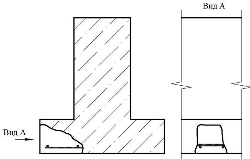
**Рисунок 44 – Пример схемы вскрытия нижнего армирования ленточного фундамента**
