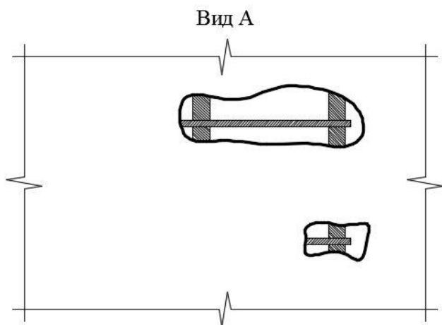
**Рисунок 51 – Пример схемы вскрытия монолитной железобетонной балки
