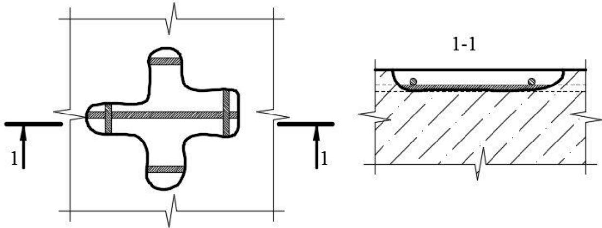
**Рисунок 43 – Пример схемы вскрытия верхнего армирования плитного фундамента**
