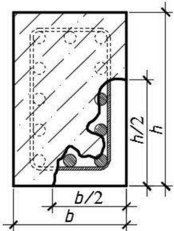
$b$  – ширина элемента фермы;  $h$  – высота элемента фермы
