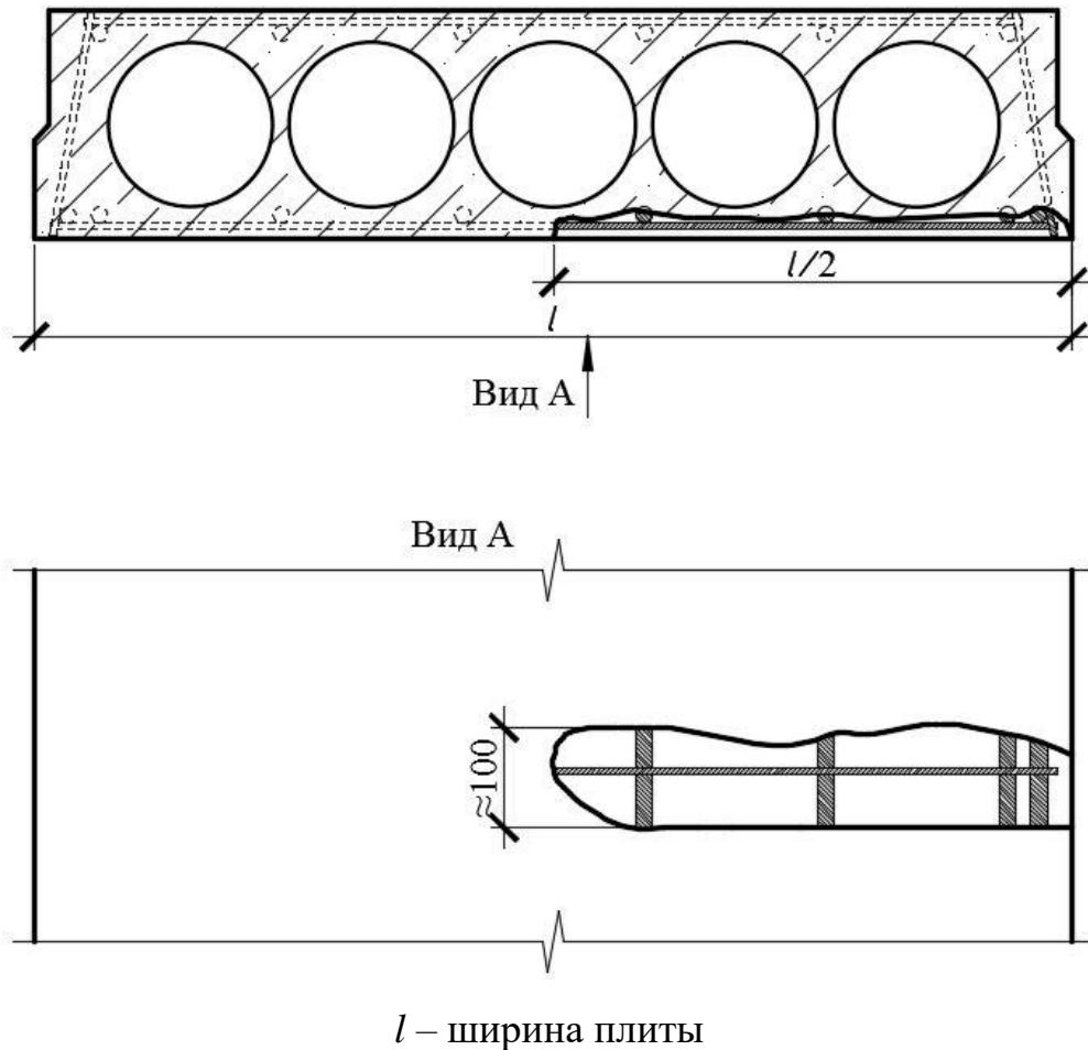
**Рисунок 55 – Пример схемы вскрытия многопустотной плиты перекрытия**
