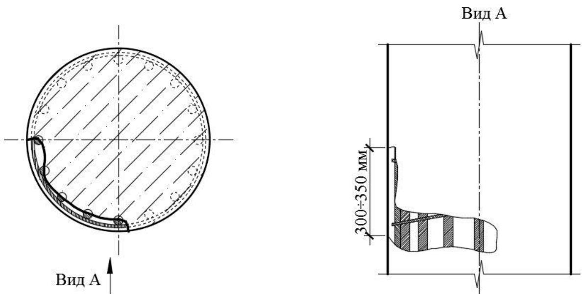
**Рисунок 47 – Пример схемы вскрытия колонны круглого сечения**
