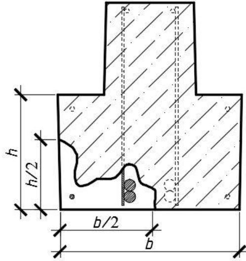
$b$  – ширина балки;  $h$  – высота полки балки
