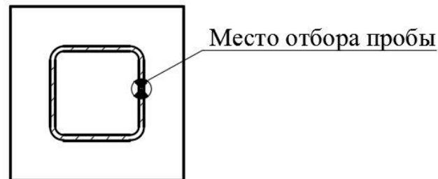
**Рисунок 28 – Схема отбора пробы из стальной колонны сечением замкнутого квадратного профиля**
