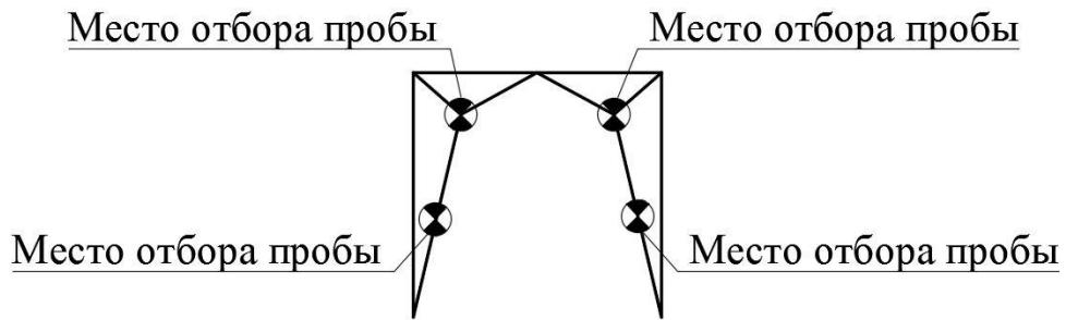
**Рисунок 36 – Схема отбора пробы из вертикальной порталной связи**
