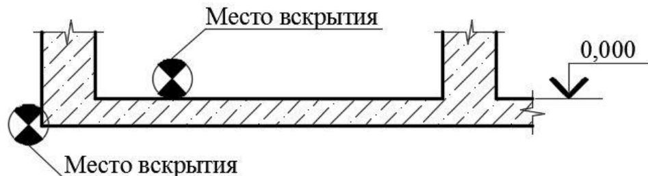
**Рисунок 4 – Пример схемы расположения места вскрытия в плитном фундаменте**
