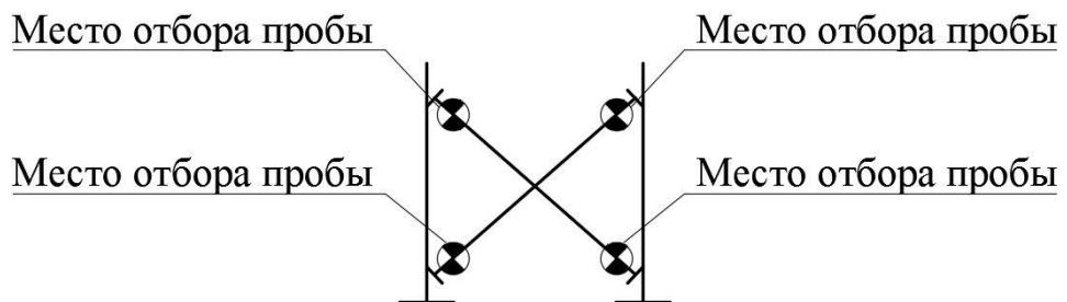
**Рисунок 35 – Схема отбора пробы из вертикальной крестовой связи**
