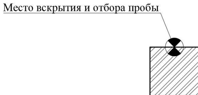
**Рисунок 22 – Схема вскрытия и отбора пробы кирпичной кладки из конструкции кирпичного столба**
