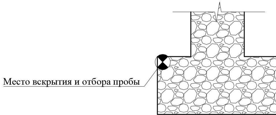
**Рисунок 18 – Схема вскрытия и отбора пробы из кирпичного (а) и бутового (б)
