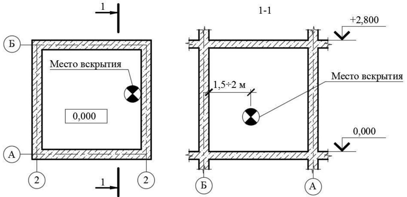
**Рисунок 8 – Пример схемы расположения места вскрытия в железобетонной стене**
