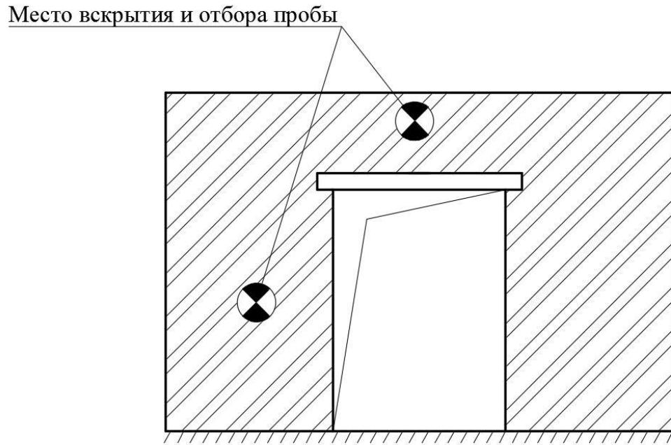
**Рисунок 21 – Схема вскрытия и отбора пробы кирпичной кладки около дверного проема**
