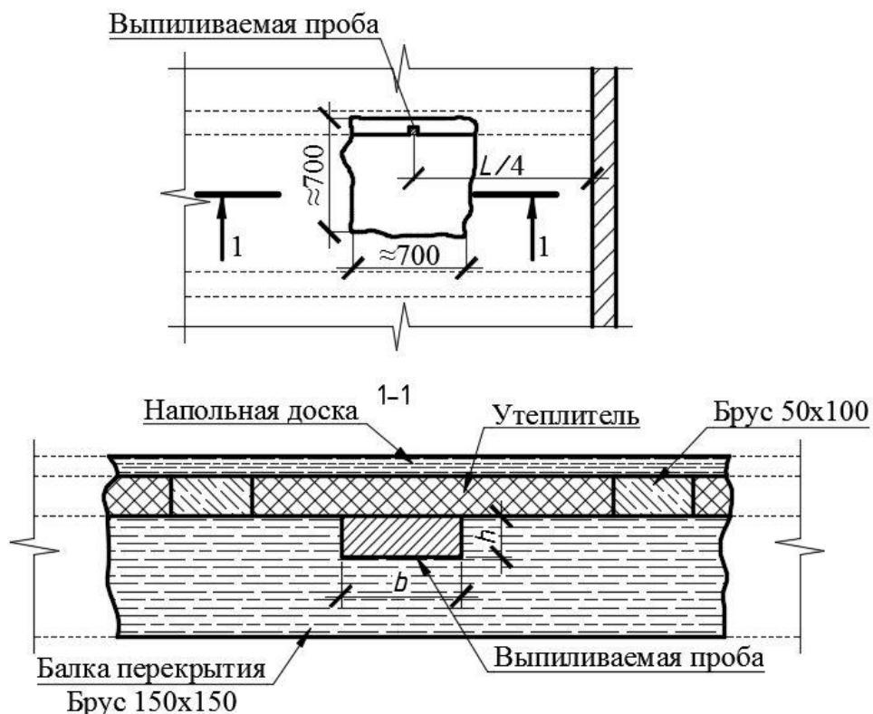
$L$  – длина пролета;  $b$  – ширина выпиливаемой пробы;  $h$  – высота выпиливаемой пробы
