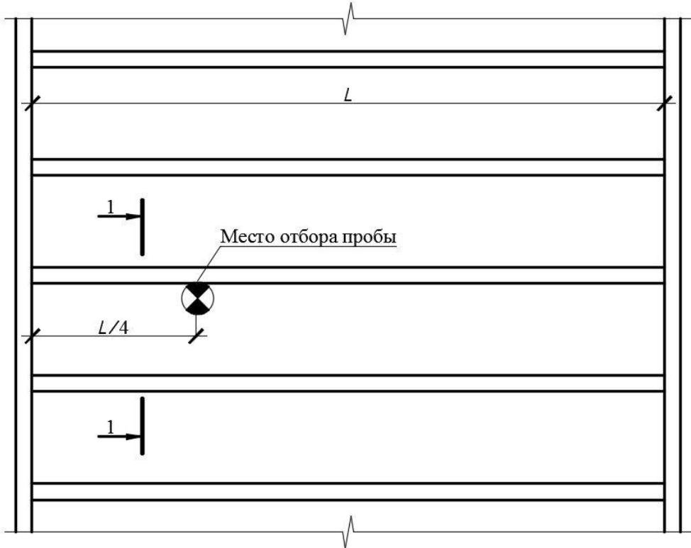
**Рисунок 42 – Пример схемы расположения мест отбора проб из деревянной балки перекрытия**
