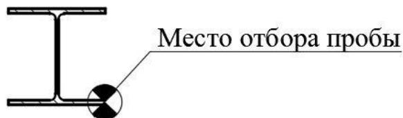
**Рисунок 31 – Схема отбора пробы из стальной балки двутаврового сечения**
