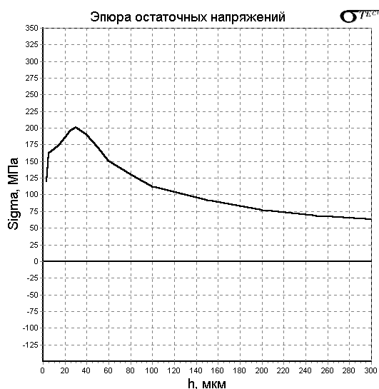
Рис.4 Эпюра напряжений до исчерпания ресурса
