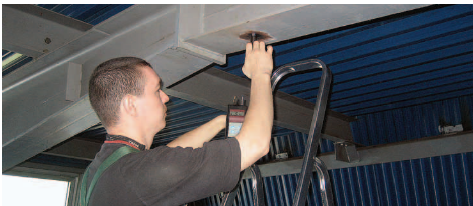
Рис. 1. Применение портативного твердомера на строительных конструкциях в полевых условиях
