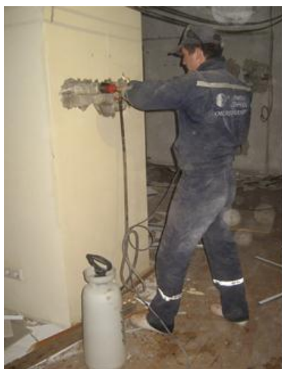
Рисунок 9. Отбор образцов кирпича
