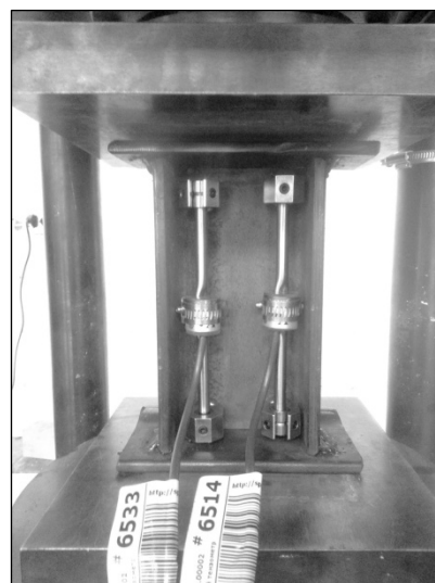
Рис. 2. Тестовый образец с тензотрами между опорными плитами прессы.
