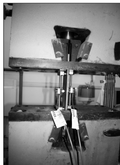
Рис. 4. Тестовый образец с тензотрами между губками разрывной машины.
