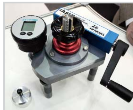
Рис. 2. Прибор для метода отрыва с диском для приклеивания к бетону
