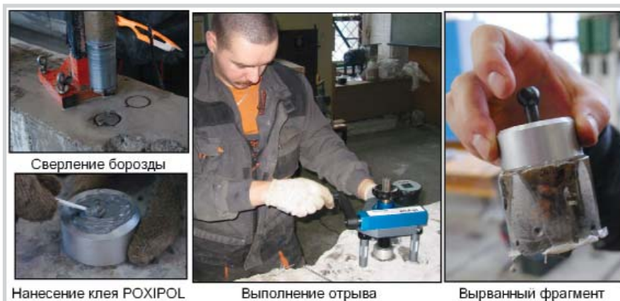
Рис. 5. Измерение прочности методом отрыва
