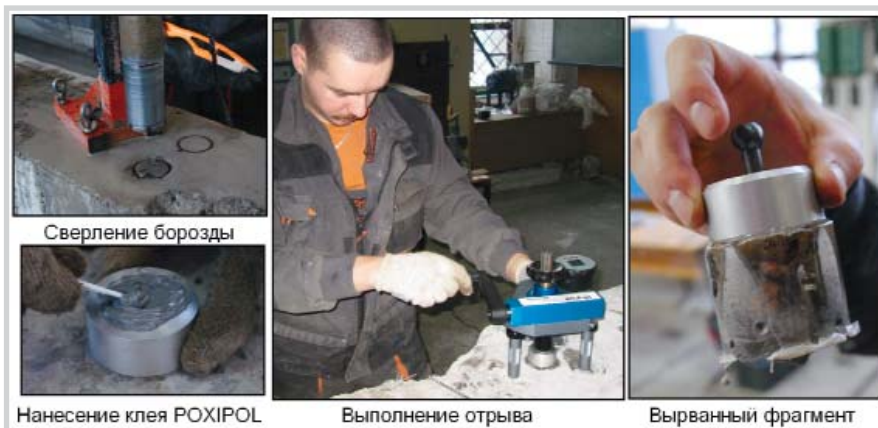
Рис. 5. Измерение прочности методом отрыва
