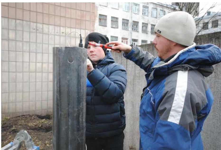
Рисунок 4. Возбуждение упругой волны в исследуемой свае
