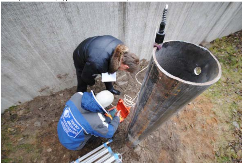
Рисунок 3. Модель сваи с установленным датчиком
