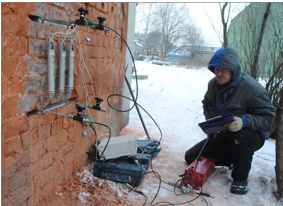
**Рисунок 3 - Испытание кладки методом плоских домкратов**
