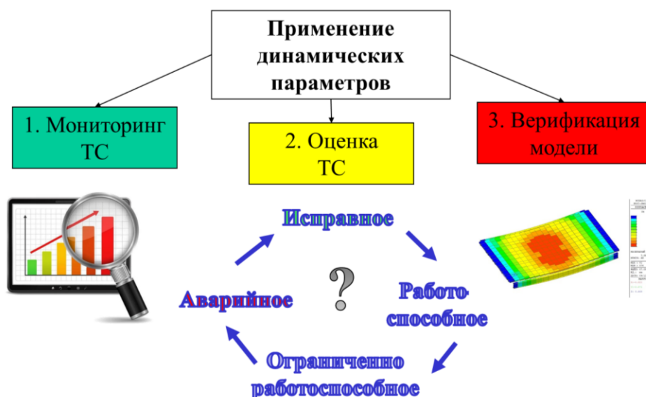
Рисунок 1 – Схема применения результатов динамических измерений
