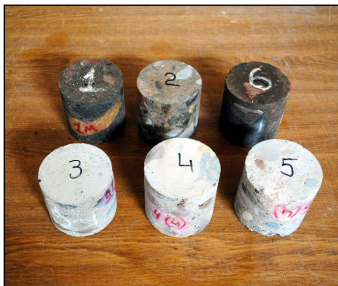
Рисунок 2 – Образцы – цилиндры, изготовленные из кернов, отобранных из перекрытия (№№1,2,6 из промасленной зоны; №№ 3,4,5 – вне зоны промасливания)
