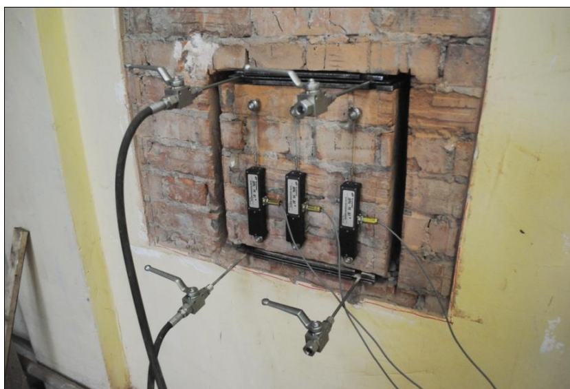
Рисунок 5 – Испытание кладки с вертикальными штрабами
