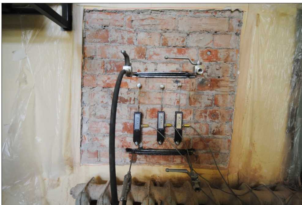
Рисунок 3 – Испытание кладки по методике ASTM 1197
