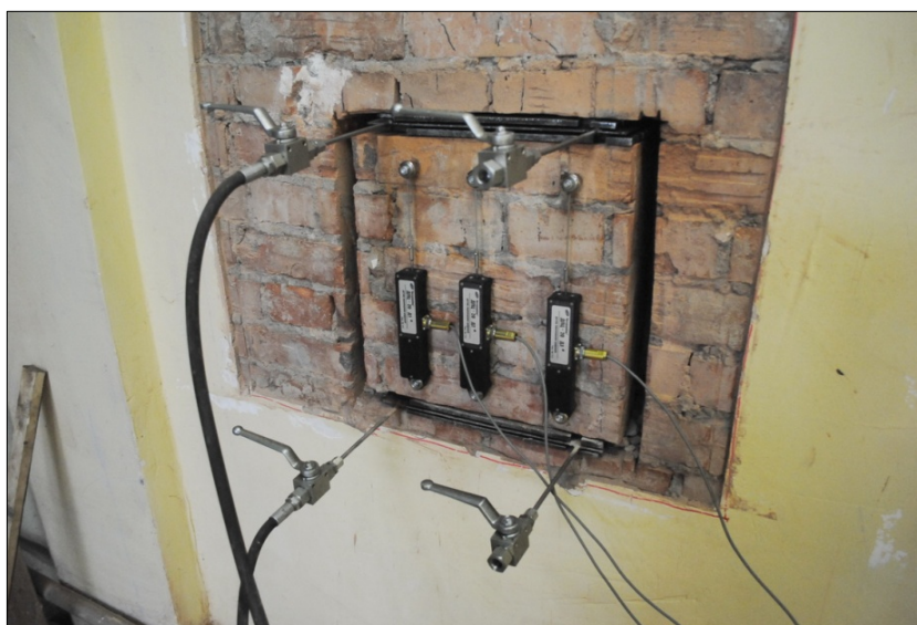
Рисунок 5 – Испытание кладки с вертикальными штрабами
