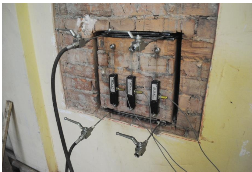
Рисунок 5 – Испытание кладки с вертикальными штрабами
