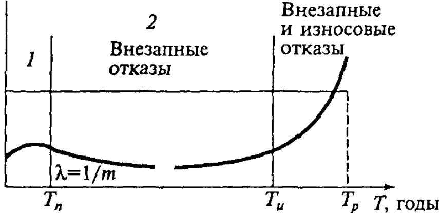
Р и с. 1.2. Интенсивность отказов элементов как функция времени эксплуатации:
