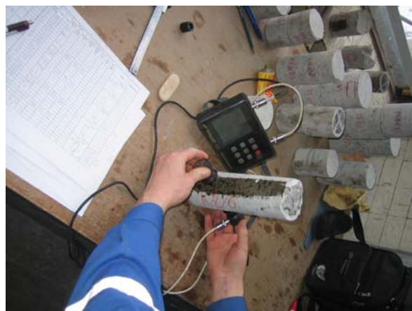
Рисунок 3. Лабораторное измерение скорости УЗВ по диаметру кернов
