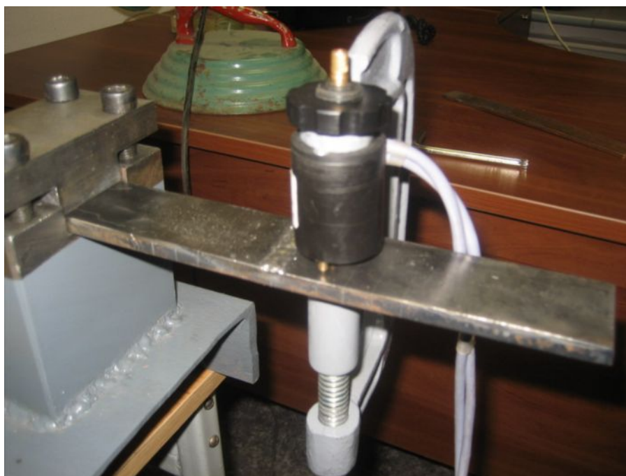
Рис.1 Схема измерения электрического сопротивления в активной зоне сварного соединения
