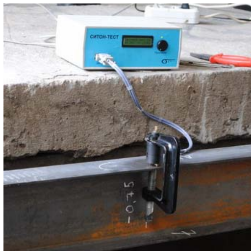
Рис. 4 Внешний вид аппаратуры СИТОН-ТЕСТ (электронный блок, датчик со струбиной)
