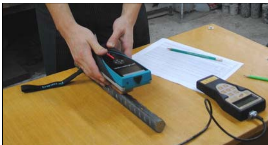
Рис. 2 Экспериментальное измерение параметров армирования
