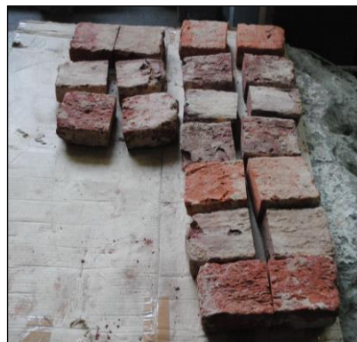
Рисунок 1. Кирпичи для испытания по стандартной методике
