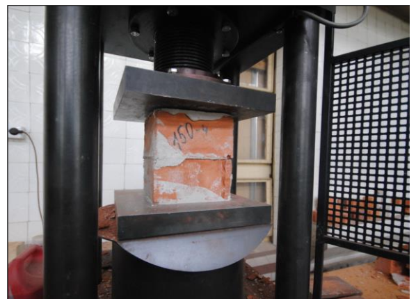
Рисунок 8. Испытание стандартного образца
